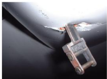
Brake part embedded in lower wing. Часть тормоза, попавшее в нижнее крыло
