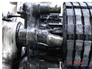
Corroded & failed brake piston. Корродированный поршень тормоза
