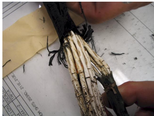
Повреждение электропроводке самолета
